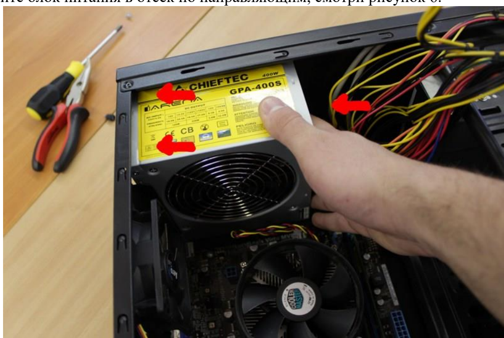
Рисунок 6 – Установка блока питания
