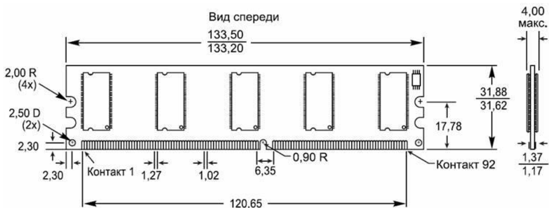
Рисунок 3.4 184-х контактный модуль памяти DDR SDRAM
