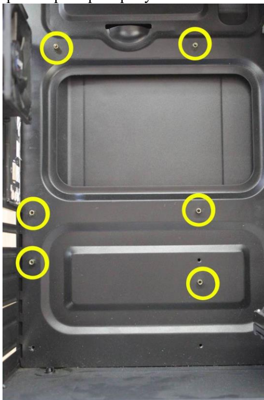
Рисунок 1 – Стойки, установленные на раме корпуса ПЭВМ
