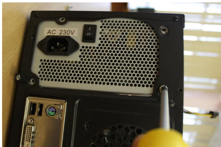
Рисунок 7 – Фиксация блока питания
