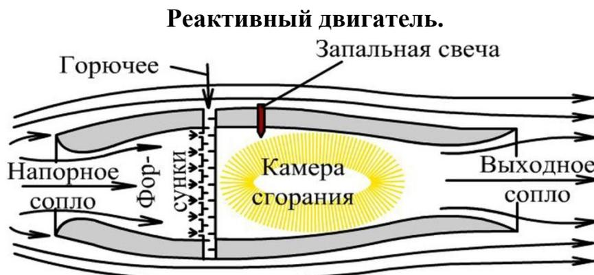
Прямоточный воздушно-реактивный двигатель используется в авиации. Его работа протекает следующим образом. При полете самолета встречный поток воздуха проходит через напорное сопло и захватывает горючее, разбрызгиваемое форсунками. Образовавшаяся рабочая смесь поступает далее в камеру сгорания, где воспламеняется с помощью запальных свечей.
